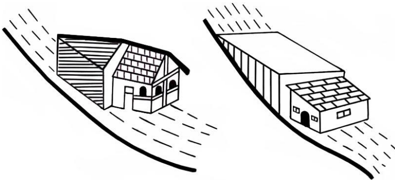
ნახ. 6.3. შესაბამისი კონსტრუქციებით საცხოვრებელი სახლების დაცვა ზვავებისაგან
