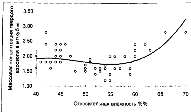
Рис. Зависимость массовой концентрации атмосферного твердого аэрозоля \Delta m от относительной влажности приземного воздуха f
