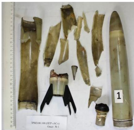
Рис. 4. Фрагменты дробления корпуса ПГИ «Ас» без применения ВВ.
