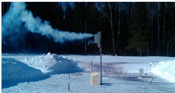
Рис.1. Наземный аэрозольный генератор НАГ-12 с системой дистанционного управления.
