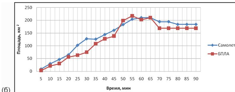
Рис.3. Максимальная концентрация частиц реагента (а) и горизонтальные размеры зон с концентрацией частиц выше  $10^4$   $1/\text{м}^3$  (б) при воздействии с БПЛА и самолёта.
