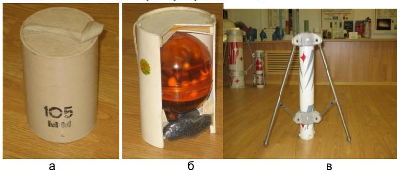
Рис.3. Генератор льдообразующего аэрозоля ГЛА-105 в сборе (а) и в разрезе (б), mortar для отстрела генератора ГЛА-105 (в).
