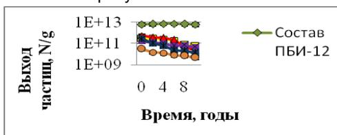
Рис.2. Динамика изменения льдообразующей активности пиросоставов при температуре -4°C.
