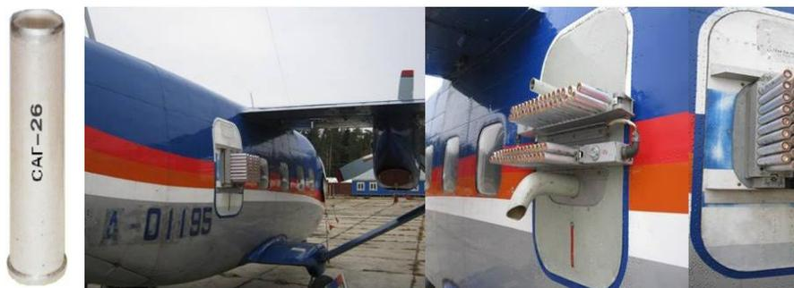
Рис.1. Самолетный аэрозольный генератор САГ-26 (а) и общий вид генераторов, установленных на самолете АН-28 (б).
