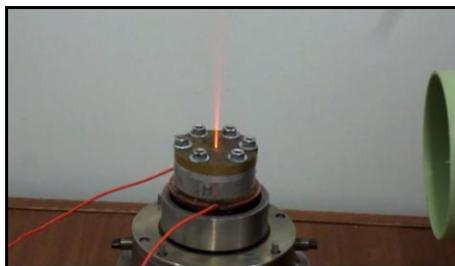
Рис.1. Устройство лабораторного сжигания пиросоствов.
