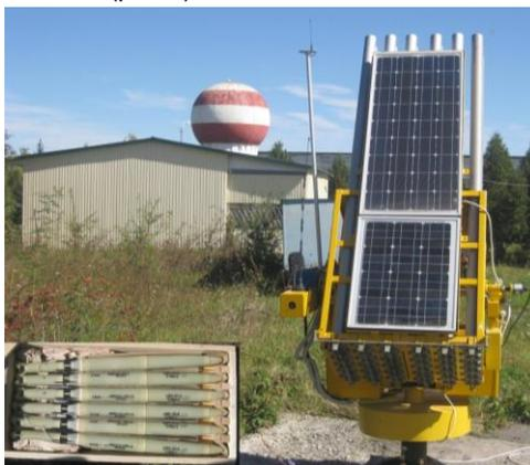
Рис.1. Автоматизированный противоградовый комплекс «Ас-Элия».
