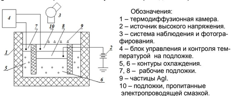
Рис. 3. Схема экспериментальной установки для исследования влияния электрического заряда на температурный порог льдообразования на частицах  $AgI$ .
