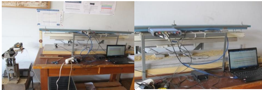
ნახ.7.3. ბურიჯ-კნოპოვის ექსპერიმენტები სუფთა ფილებით და ფილებს შორის ქვიშის ფენით
