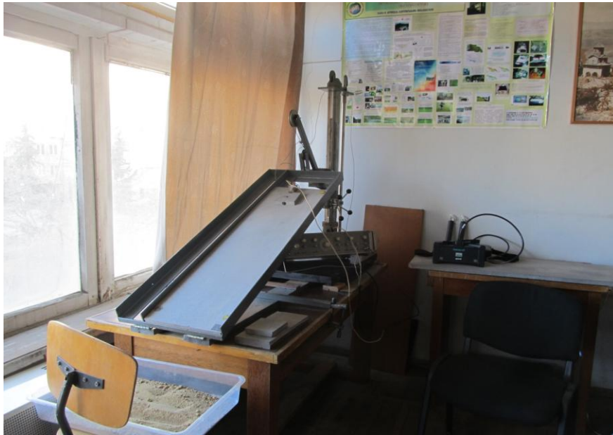
ნახ.5.4. დანადგარი დახრის ცვლადი კუთხის მქონე ბაზალტის ფილაზე ნიმუშების გადაადგილების შესასწავლად.
