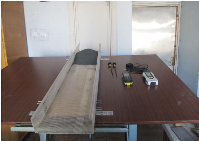
ნახ.5.7. დანადგარი დახრის ცვლადი კუთხის მქონე დახრილ ზედაპირზე ფხვიერი მასალების გადაადგილების შესასწავლად.
