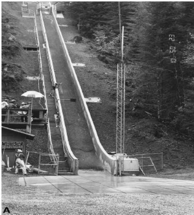
ნახ.1.13. შერთებული შტატების გეოლოგიური სამსახური (USGS), ღვარცოფული არხი [Iverson et al., 1992]. (ა) მიმდინარე ექსპერიმენტის ფოტო, (ბ) ვერტიკალური ჭრილის სქემა.
