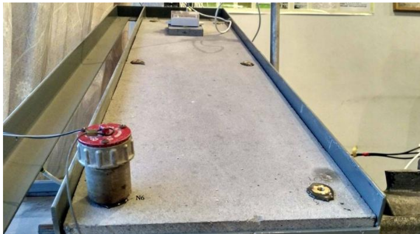
ნახ.5.6. სამაგრი წერტილები ბაზალტის ფილაზე (მარცხენაზე დამაგრებულია დაბალსიხშირული სეისმომომღებები)
