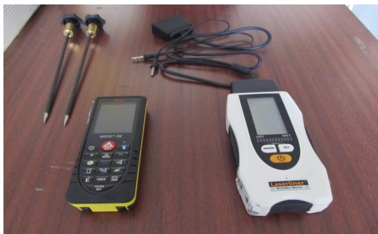
ნახ.5.5. ლაზერული მანძილმზომი და დახრილმზომი. გრუნტის და მასალების ტენიანობის გამზომი.
