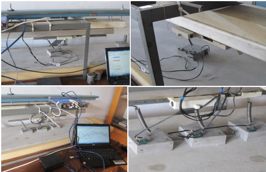
ნახ.7.1. ბურიჯ-კნოპოვი ერთ და სამფილიანი ექსპერიმენტები
