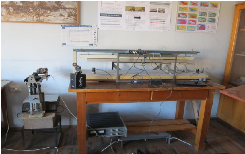
ნახ.5.1. დანადგარი ბაზალტის ფილაზე ნიმუშების ჰორიზონტალური გადაადგილების შესასწავლად.
