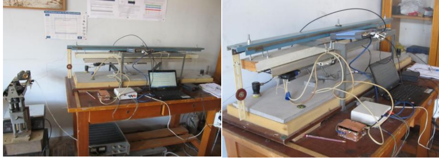
ნახ.7.4. ბურიჯ-კნოპოვის ექსპერიმენტი ორი ფილის შემთხვევაში. ხდება ფილების აჩქარებების, აკუსტიკური ემისიის და გამწევი ძალის რეგისტრაცია.
