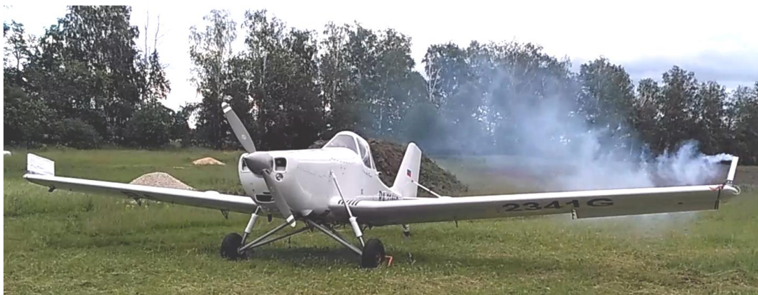
Рис. 6. Наземные испытания самолета МВ-500 с установленным аэрозольным комплексом САГ-26-КС.
