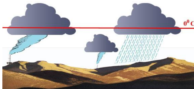
Рис. 1. Схема воздействия наземными аэрозольными генераторами.
