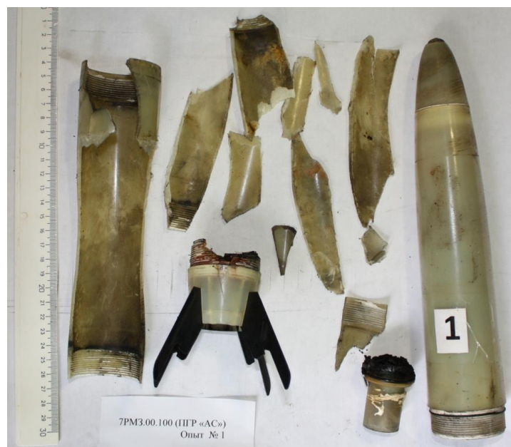
Рис. 4. Фрагменты дробления корпуса ПГИ «Ас» без применения ВВ.
