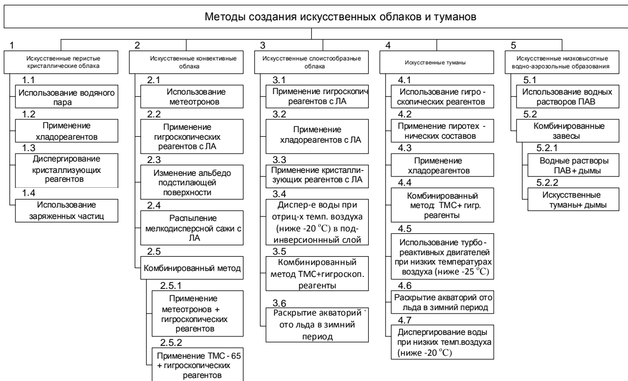
Рис. 2. Методы создания искусственных облаков и туманов.
