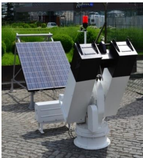
Рис. 3. Фотография одного из современных пунктов воздействия на градовые процессы в Кахетии.
