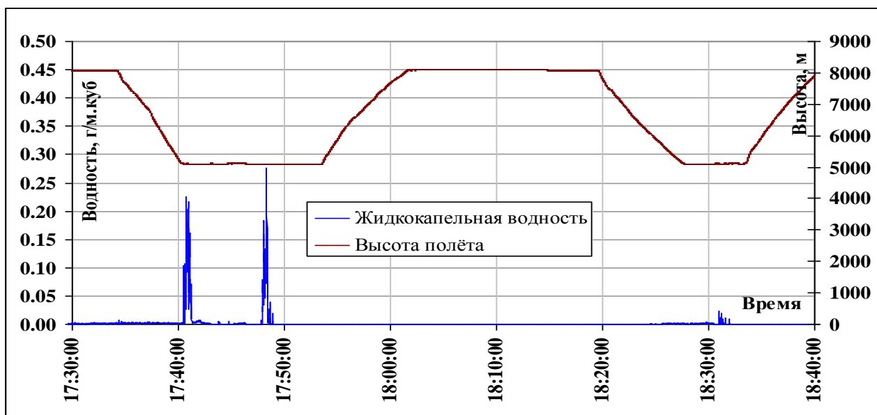
Рис. 5. Измерения жидкокапельной водности при пересечении облака.
