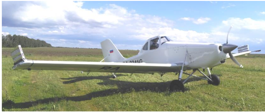
Рис.5. Самолет МВ-500 с установленными на законцовках крыльев кассетами - САГ.
