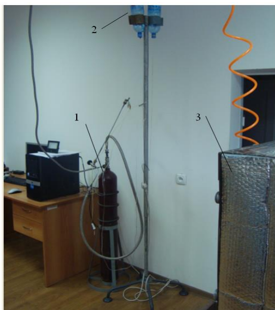
Рис. 1. Комплекс аппаратуры для распыления водного раствора реагента. 1– баллон со сжатым воздухом, 2– емкости с раствором реагента, 3 – малая облачная камера.
