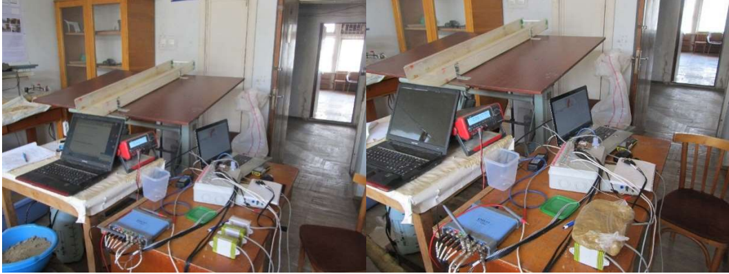
ნახ.9.2. ლაბორატორიული ექსპერიმენტები მიკრორადარის საშუალებით მეწყრული გრუნტის (გლდანის მეწყერი) ტენიანობის გაზომვისათვის
