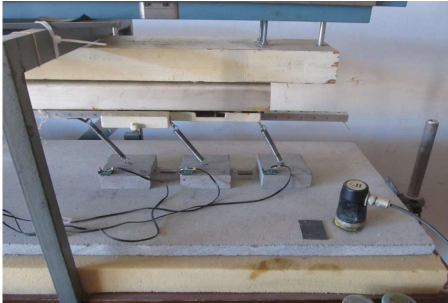
სურ.4.1. დანადგარი ბაზალტის ფილაზე ნიმუშების ჰორიზონტალური გადაადგილების შესასწავლად. საქაჩი ურიკა ჩამიკიდული ნიმუშებით.
