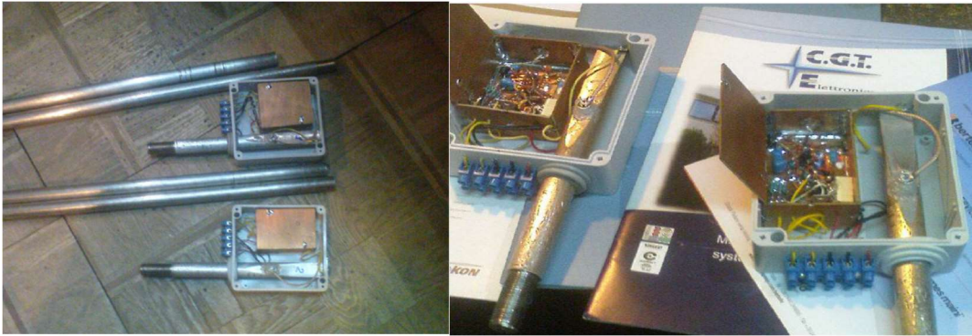
ნახ.4.9.უქანგავი ფოლადის მილები აკუსტიკური სიგნალის გადაცემისათვის და აკუსტიკური სენსორი
