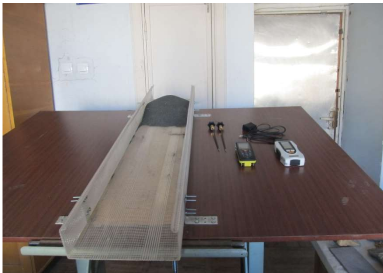
ნახ.4.5. დანადგარი დახრის ცვლადი კუთხის მქონე დახრილ ზედაპირზე ფხვიერი მასალების გადაადგილების შესასწავლად.
