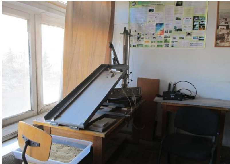
ნახ.4.2. დანადგარი დახრის ცვლადი კუთხის მქონე ბაზალტის ფილაზე ნიმუშების გადაადგილების შესასწავლად.
