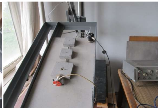
ნახ.4.3. ა) ლაბორატორიული მოდელი გამწევი ძალის გარეშე ექსპერიმენტების სერიის ჩასატარებლად, ბ) და გ) ექსპერიმენტი ერთფილიანი მოდელისათვის გამწევი ძალის გარეშე. ფილაზე მიმაგრებულია CB-20 ტიპის სეისმური ვიბრატორი, დ) ექსპერიმენტი სამფილიანი, ბურიჯ-კნოპოვის, მოდელისათვის, გამწევი ძალის გარეშე
