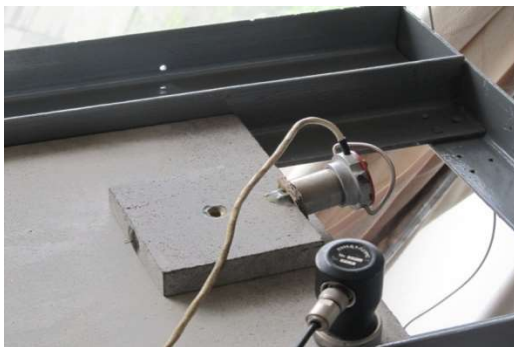
ნახ.4.3. ა) ლაბორატორიული მოდელი გამწევი ძალის გარეშე ექსპერიმენტების სერიის ჩასატარებლად, ბ) და გ) ექსპერიმენტი ერთფილიანი მოდელისათვის გამწევი ძალის გარეშე. ფილაზე მიმაგრებულია CB-20 ტიპის სეისმური ვიბრატორი, დ) ექსპერიმენტი სამფილიანი, ბურიჯ-კნოპოვის, მოდელისათვის, გამწევი ძალის გარეშე
