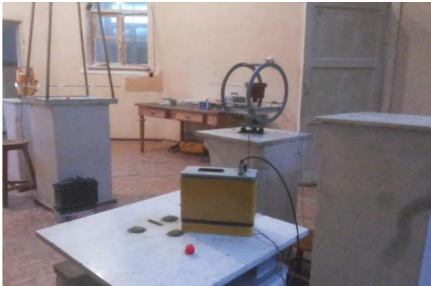
სურ. 6. პროტონული მაგნიტომეტრი MMPI-203 ჰელმჰოლცის კოჭათი
