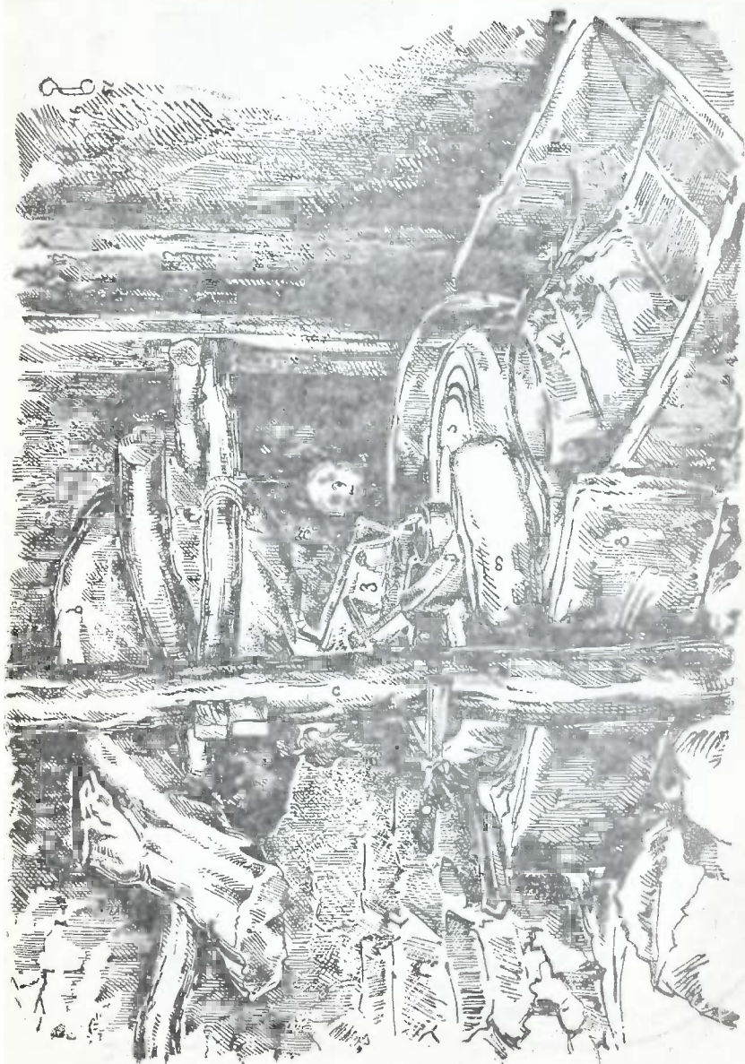
Рабочая машина водной мельницы. а. Верхний жернов (верхник, бегун); б. Ящик для засыпки зерна (мельничная воронка); в. Гнездо жернова; г. Ящик для выбирания муки; д. Потрясок; е. Деревянный желоб для прохождения зерна; ж. Регулирующий механизм для подачи зерна в глаз бегуна; з. Деревянный защитный круг рабочей машины; и. Деревянные опоры.
